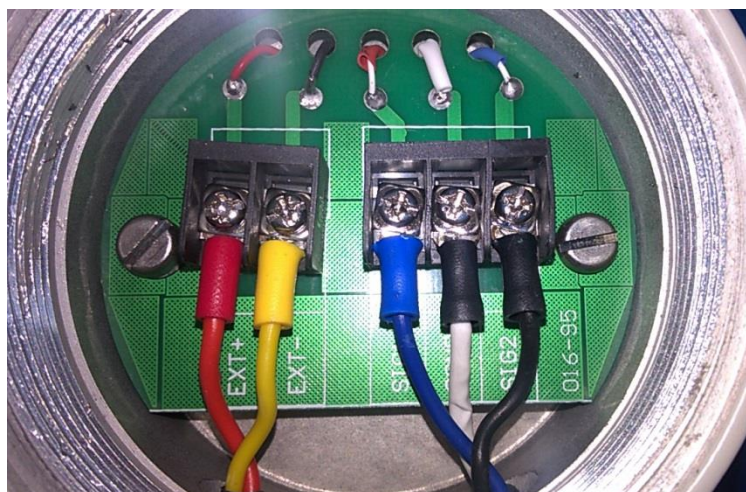
Rys. 3d Połączenia przewodów pomiarowych, czujnik - przetwornik
