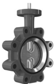
Przepustnica międzykołnierzowa, centryczna, żeliwna z klapą nierdzewną 304 typu LUG nr 4495
